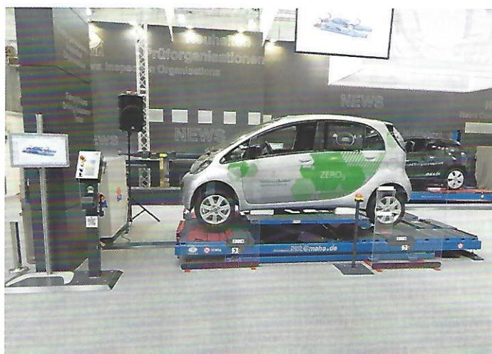
Společnost Maha se prezentovala několika zajímavými exponáty. Jedním z nich byla i nová válcová zkušebna Duo určená i pro vozidla s pohonem všech kol.
